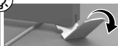
Afin de faciliter l'insertion de coulisseau dans le second profil, vous pouvez lever la porte à l'aide de l'accessoire de pose en vous en servant comme d'un levier
