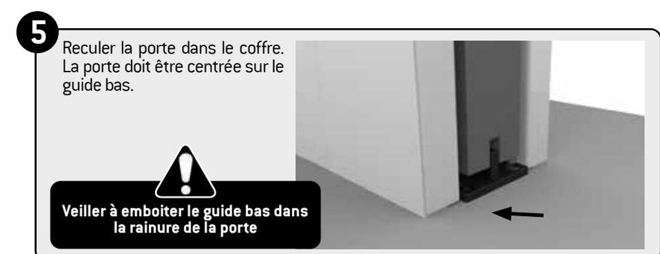
Reculer la porte dans le coffre. La porte doit être centrée sur le guide bas.
